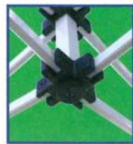
スムーズなオートピーク式機構。接合部に強化プラスチック(グラスファイバー+ナイロン6化合物)を使用することにより、こすれや錆を防止します。天幕の張りを持たせるために、オートピーク内に強固な弾力スプリングを内蔵しています。(実用新案登録No.3058526号)
