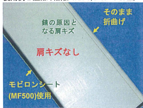
使用例2 (亜鉛メッキ鋼板 1.2t P/D=88° V=10mm)
