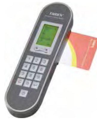
HCS-4390NEK10 ワイアレス投票ユニット (ポータブル、10投票キー、ICカード)
