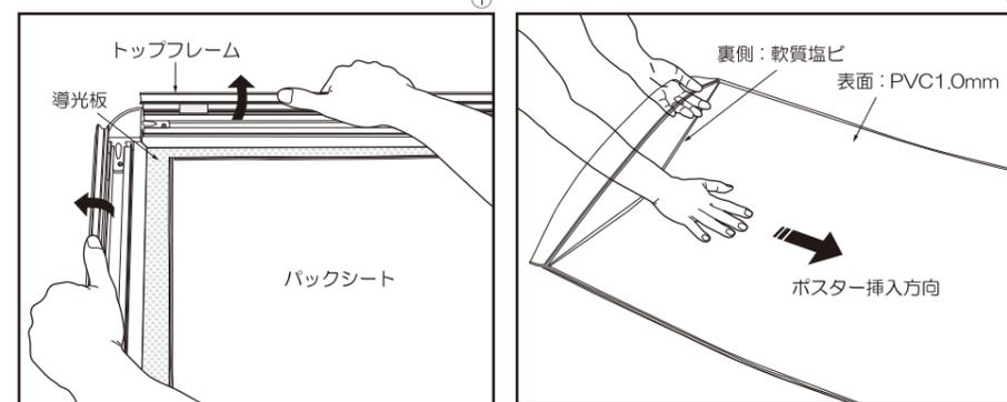
フレームを4辺手で開きます。防水電飾用バックシートがセットされているので外します。開閉時に指を挟まない様にお気をつけ下さい。
