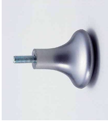
材質 ①ボルト：鋼(3価クロメート) ②本体：ABS ③底脚：ABS
