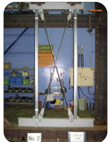
ブレースパネルの実大実験
