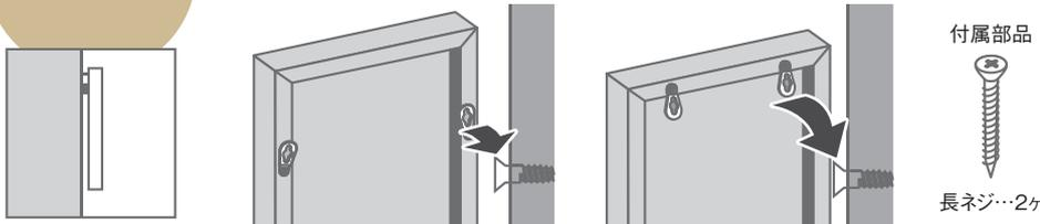
長ネジを壁面に取り付け、吊り金具を引っ掛けます。
