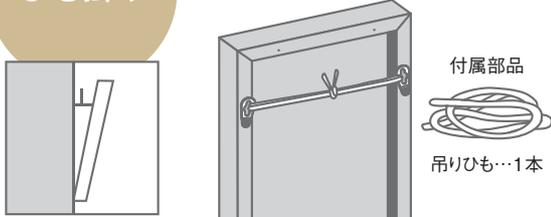
吊金具に付属の吊りひもを通して結びます。
