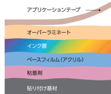
従来のフィルムでは施工が難しかった凹凸面に貼り付け可能なフィルム。ペイントフィルムは特殊アクリルフィルムに溶剤系インクジェット等で印刷し、粗面への接着を可能にしたグラフィックシートです。
