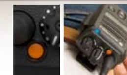
サイレン音とLEDの発光で周囲に緊急を知らせます。5色に発光するLEDランプは腰につけたまま確認でき、点灯/点滅する色によって、無線機の状況や通信モードが確認できます。
