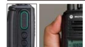
グローブをしたままでも押しやすい大型PTTスイッチです。下部には、モニターボタン、バックライトボタンが配置されています。
